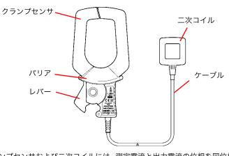
クランプセンサおよび二次コイルには、測定電流と出力電流の位相を同位相に するための電流方向マークが付いています。
